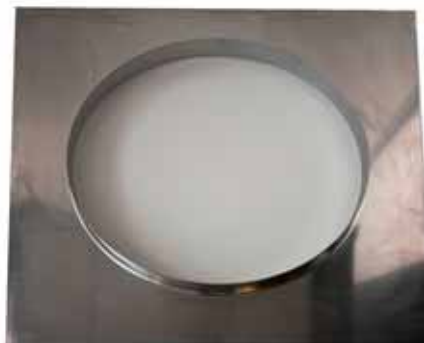
Solin carré plane, base maximum 1000*1000mm, disponible pour tous les diamètres et réalisable avec plusieurs matériaux (acier aluminisé, Aluminium recuit, inox, cuivre, etc.). Pliable au besoin, pour installation sur réhausse type costière.
